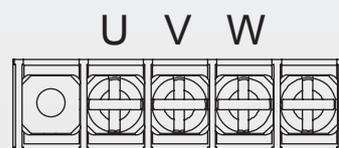
电机三根出线分别接入驱动器U、V、W端子, 调换任意两根电机接线可改变电机的运行方向。
