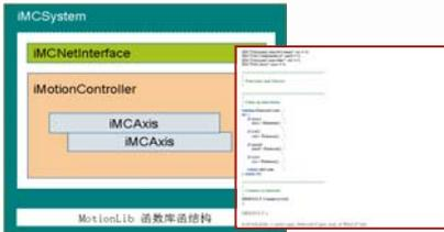
当用户使用 PC 机作为上位机时, 用户可以利用 MOTEC<sup>®</sup> 智能步进驱动器随机提供的 DLL 动态链接库实现用户的应用。动态链接库将各种运动控制命令封装于 DLL 函数库内, 用户可以非常方便地在 PC 机上利用 VB、VC 等高级语言编写应用程序, 完成二次开发。
